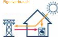
Haushalt **MIT** Photovoltaik-Anlage; Zukauf von Strom zeitweise notwendig
